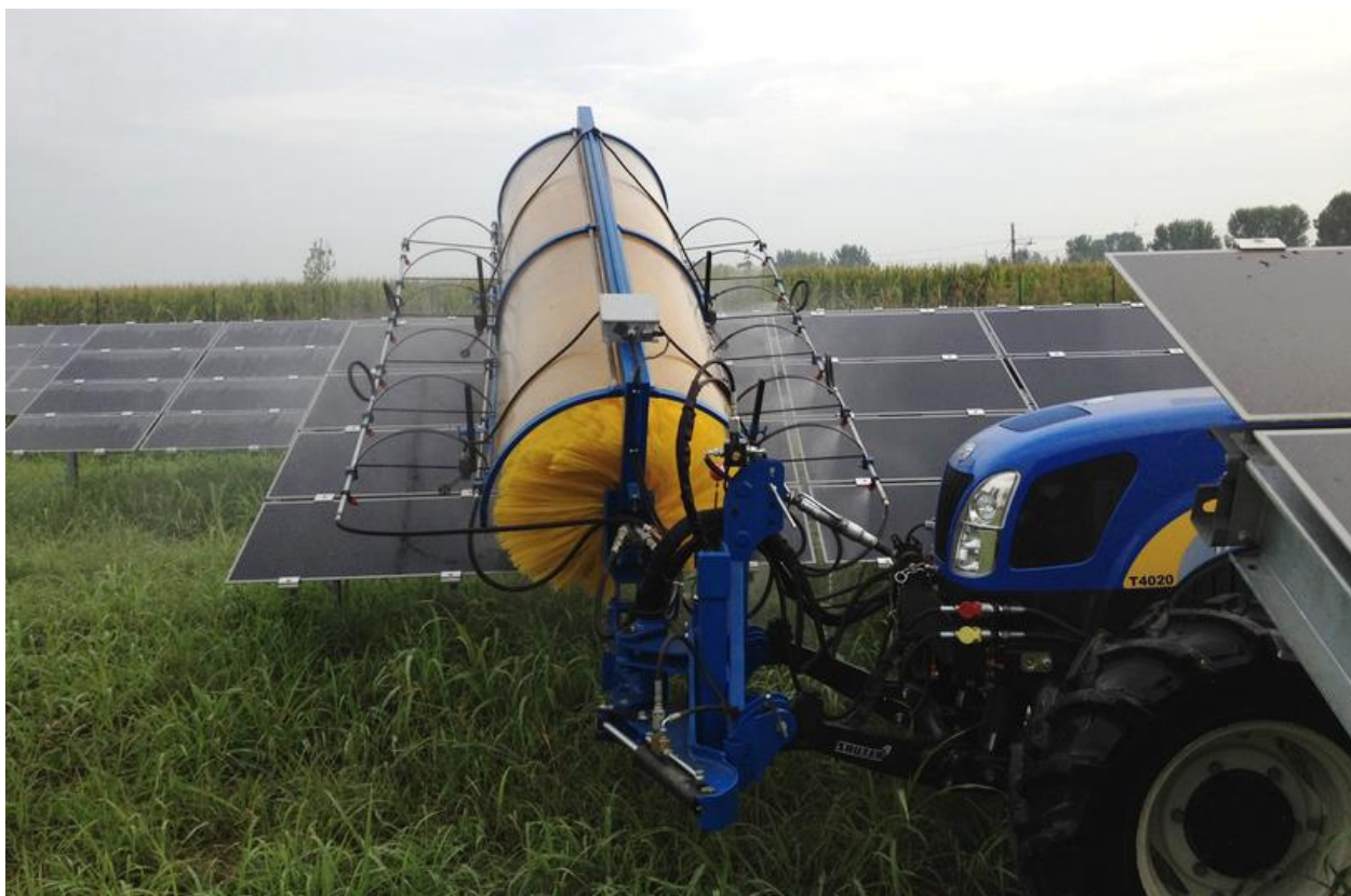
Zdjęcie nr 19. Mycie paneli fotowoltaicznych za pomocą specjalnej dostawki do ciągnika rolniczego.
